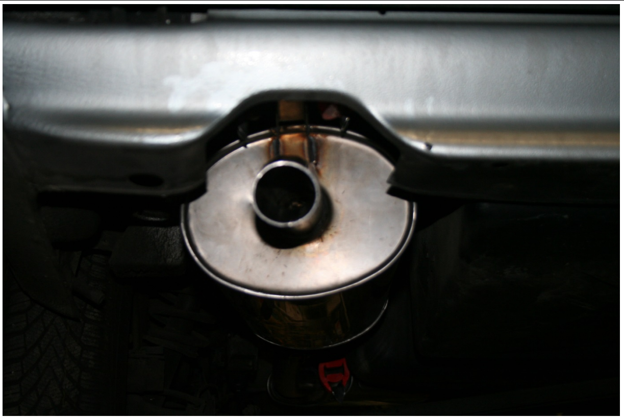
Endrohr von hinten. Unsicher zu sehen, dass das Endrohr richtig im Ausschnitt positioniert ist.
