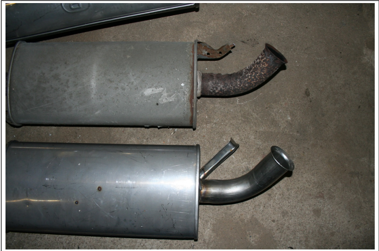
Rohre MSD zum ESD.
