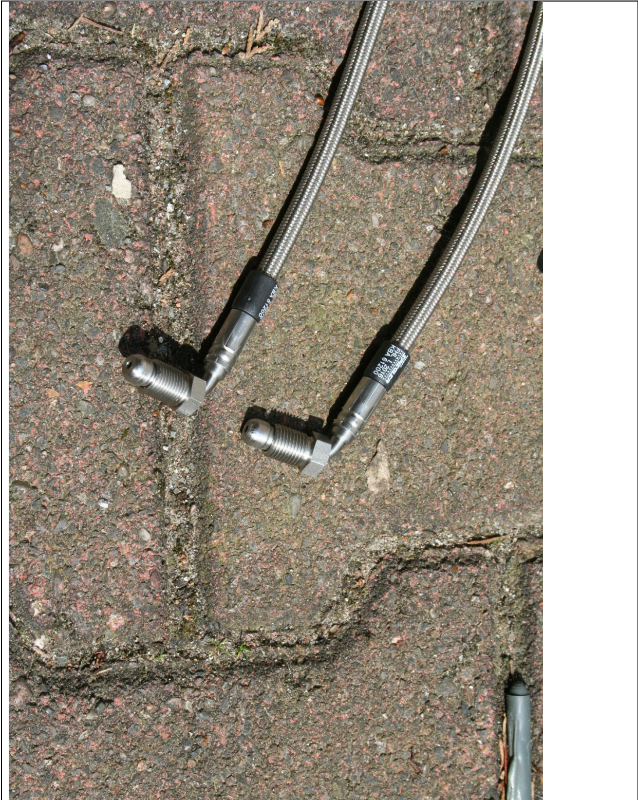
Spiegler-Leitungen Anschluss zum Mengenteiler.
