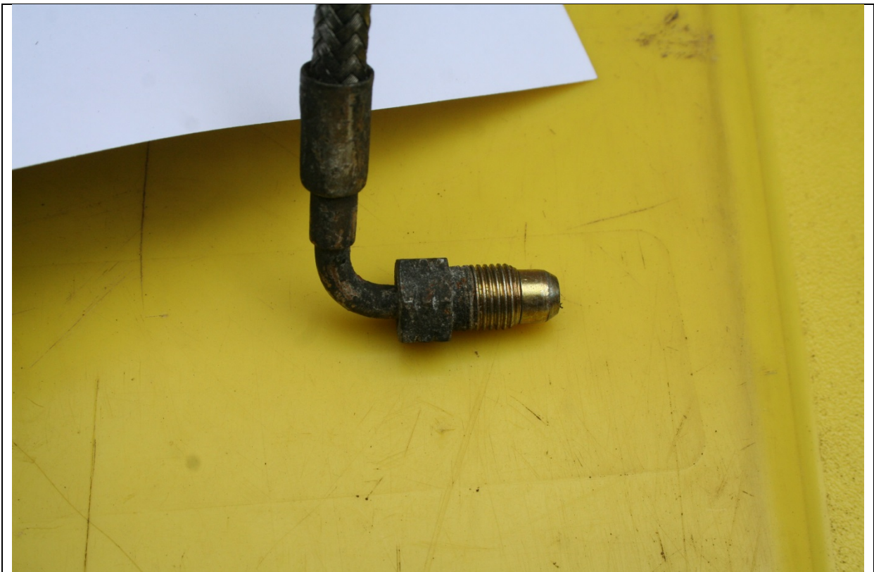
Original Leitung Anschluss am Mengenteiler
